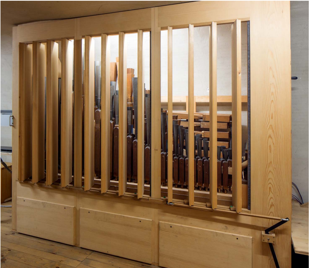
Der Schwellkasten in der „Tonhalle“ mit den durchschlagenden Zungenregistern (2001)
