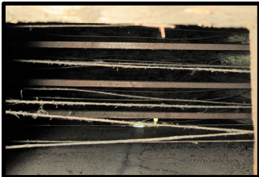
34. L'intérieur d'un des soufflets d'origine avec des cordes et des barres en bois pour maintenir les plis en peau.
