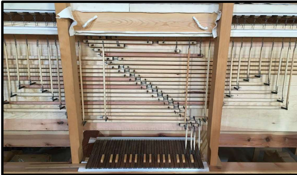
40. Abrégé de l'orgue avec ses vergettes en phase de construction.
