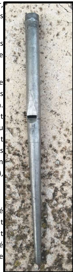
30. Tuyau original du XVI e siècle qui a servi de modèle pour la nouvelle tuyauterie.
