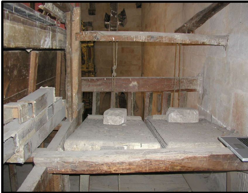
36. Soufflets installés à l'arrière de l'orgue.
